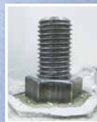
【新品ボルトで試験 右側 塗布 錆発生なし】 塩水複合サイクル試験(JIS H8502) 120サイクル(40日間)
