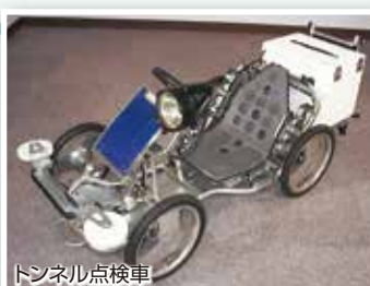
トンネル点検車
